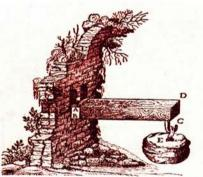
Illustrazione di prova sperimentale di rottura di una mensola con un carico applicato all'esterno libero, tratto da; "Discorsi e dimostrazioni matematiche" di Galileo Galilei,
